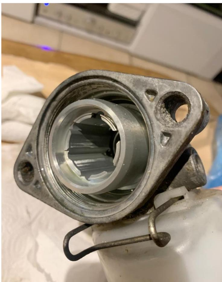
*Figure 4 - MC après démontage de la cloche*
