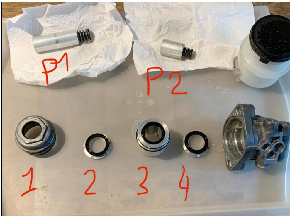
Figure 6 - Vue éclatées - ordre de dépose des pièces
